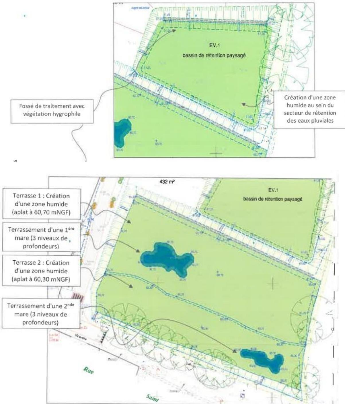
Figure 33 : La zone de rétention du lotissement avec les ouvrages et les différents cortèges végétaux pouvant se développer (GEOUEST, 2017)
