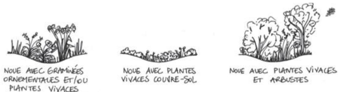
Il existe plusieurs profils de noues et fossés : les profils en travers et les profils longs. Dans le cas de profils longs avec des pentes supérieures à 2%, des redents permettent de préserver les ouvrages et d'améliorer leur rôle de rétention/infiltration, et peuvent également devenir le support de traversées pour piétons.
